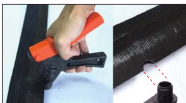
ใช้ตัวเจาะ HPL จะรูยังตำแหน่งที่ต้องการติดตั้งเทปน้ำหยดแยกจากท่อแบบ
