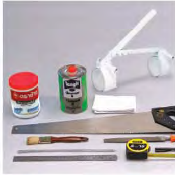
1. เครื่องมือและอุปกรณ์ประกอบที่ใช้ในการต่อประกอบท่อ เช่น ปากกา เลื่อย ตลับเมตร หน้ำยาทำความสะอาดท่อ หน้ำยาหล่อลื่น ตะไบ ผ้า และ Puller
